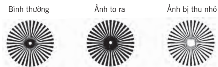
Thang kiểm tra hình sao của Gaft khi được phóng to cho thấy hình ảnh ở các trạng thái: bình thường, bị lớn lên và bị thu nhỏ
